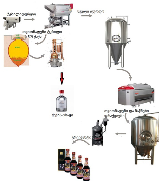
ნახ. 3. თეთრი ჯიშის ყურძნისაგან ჭაჭის არყის წარმოების კომპლექსური ტექნოლოგიური პროცესის სქემა
